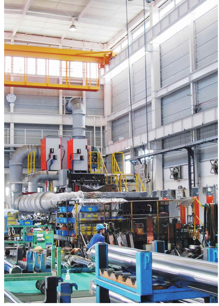
めっき液は腐食に強いチタン製で強固なピットに収納され、環境対策にも力を入れている
