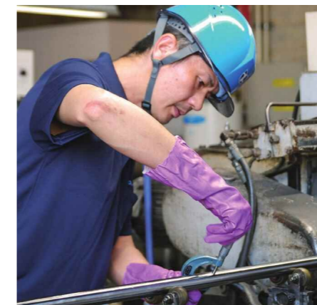
研削後の精度を測定器で確認
