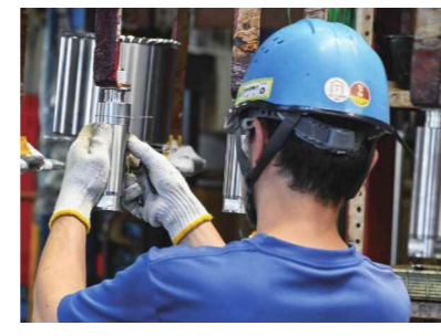
腐食やサビに強いニッケルを、電気を使わずめっきする「無電解ニッケルめっき」の加工中画像
