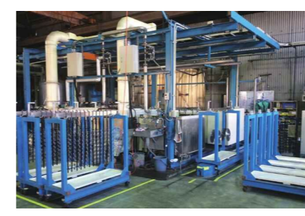
硬質クロムめっきのほかに同社が手掛ける「無電解ニッケルめっき」の自動ライン
