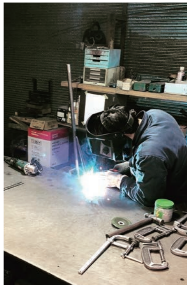
アイアン脚溶接作業
