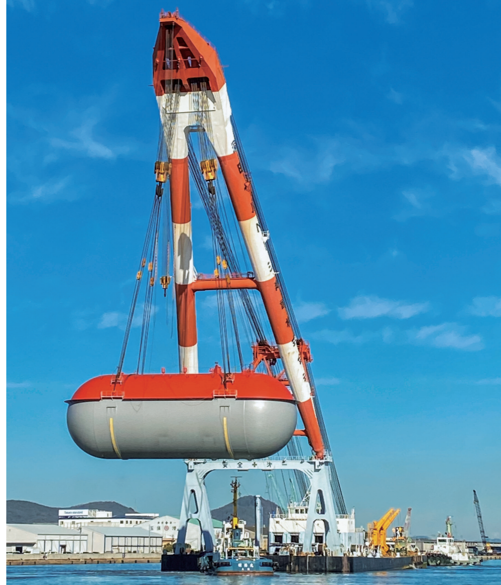
常温加圧式タンクとして世界最大の容量6,500m 3 を製造
