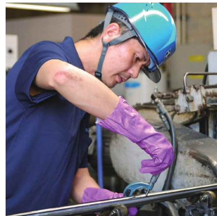
研削後の精度を測定器で確認
