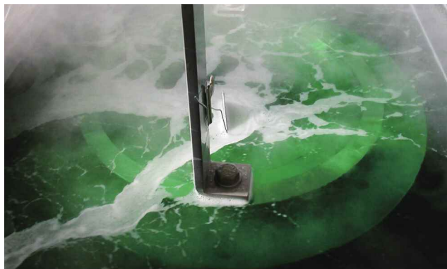
腐食やサビに強いニッケルを、電気を使わずめっきする「無電解ニッケルめっき」の加工中画像
