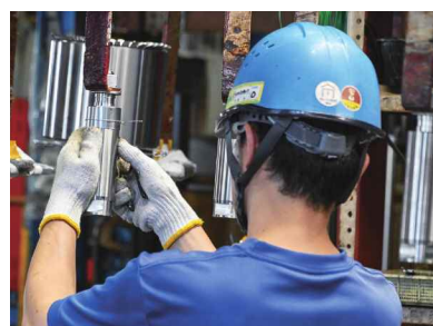
腐食やサビに強いニッケルを、電気を使わずめっきする「無電解ニッケルめっき」の加工中画像
