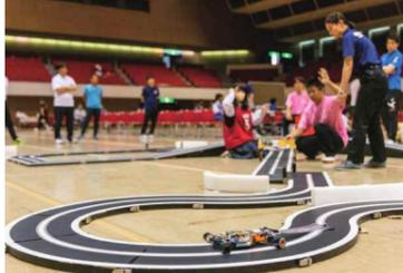
マイコンカーとは、マイコン(小さなコンピュータ)を載せた車のこと。車体の頭部にあるセンサーで、コース中央の白線を認識しながら、自動で走らせてタイムを競います。
