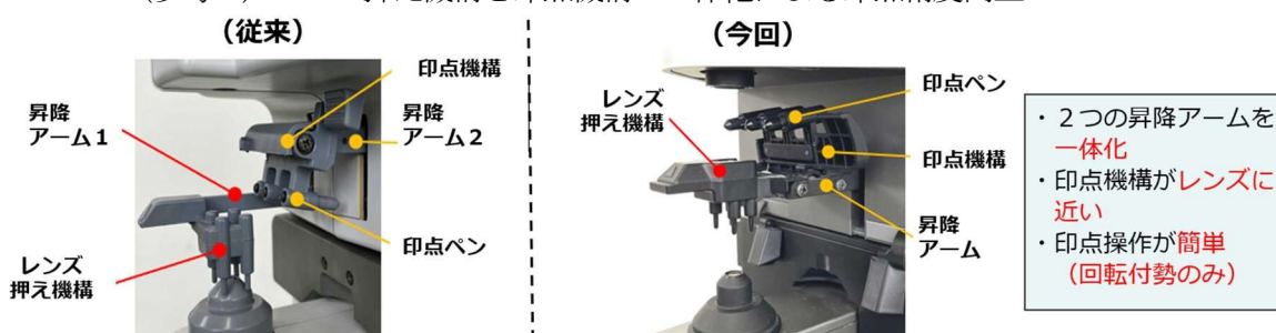
(参考2) レンズ押え機構と印点機構の一体化による印点精度向上
