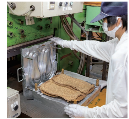
金型を使った型抜き工程。素材の配合から構造までハンドメイドにより一つ一つ丁寧に作られる。
