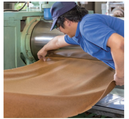
シート状に成形されるオリーブコルク。端材も、再びこの工程でシート状にし、有効活用を図っている。
