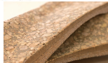
それぞれの素材や形状が、心地よく足を守る4層構造。2層目はクッション性の高い合成ゴムのラバー素材。3層目は、足をしっかりとアシストするオリジナル樹脂コルクが使われている。
