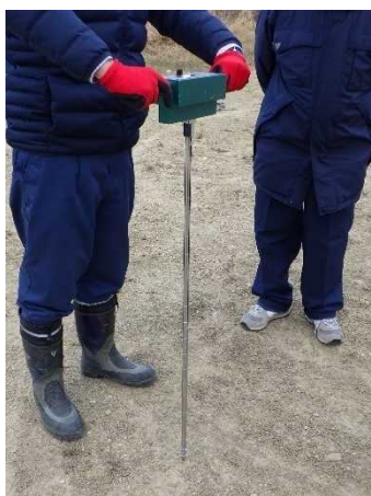
写真 13 コーンペネトロメーターでの測定
