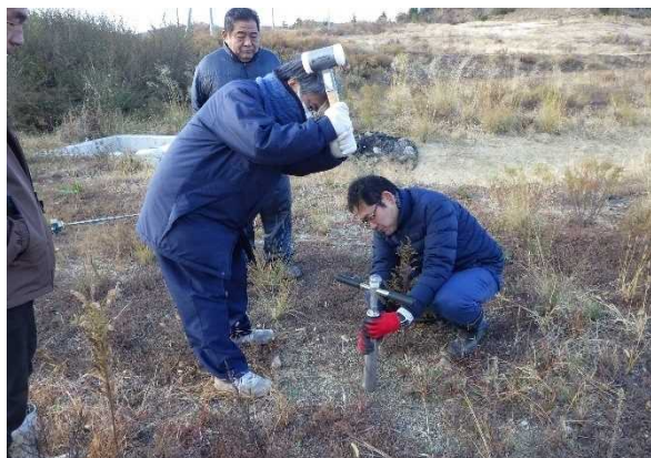
写真1 土壌サンプラーによる土壌採取
