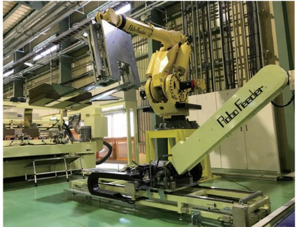
材料自動供給ロボット ロボ・フィーダー®
