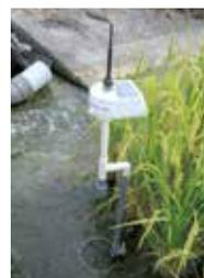
試験運用中の「水位センサー」。スマート農業の取組みにも積極的です。
