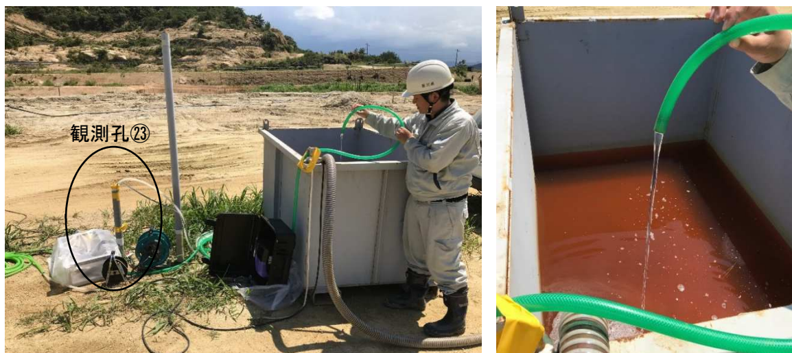
写真1 観測孔㉓における揚水試験の状況(右側は揚水の拡大写真)
