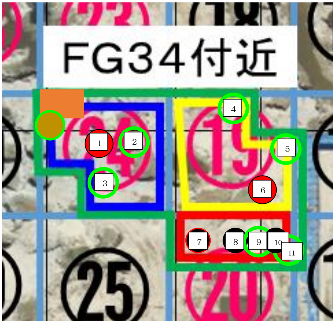
図4 底面からの滲み出しが確認された地点 ※黒丸 (No. 7, 8, 10) 地点は観測孔 (T. P. +1m~-3.5m)
