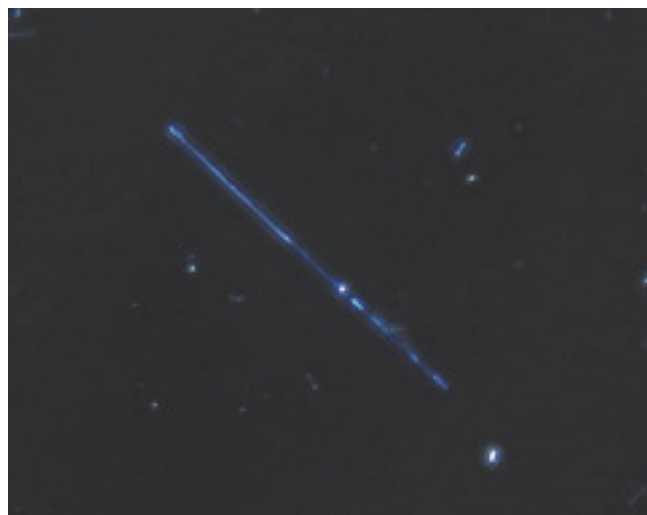
トレモライト/アクチノライトの顕微鏡写真（倍率：×400） トレモライト/アクチノライトが青く発色して見える。
