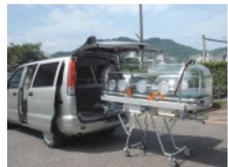
搬送車とトランジットアイソレーター （患者を乗せる寝台：外部より気圧が低く、ウイルスを閉じ込める構造）
