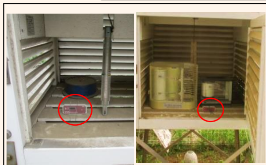
小学校の百葉箱内に温湿度計を設置した様子
