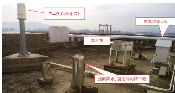
図1 環境保健研究センターのモニタリングポスト及び採取装置
