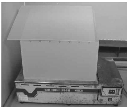
図2 ポリプロピレン製蒸発装置(正面)
