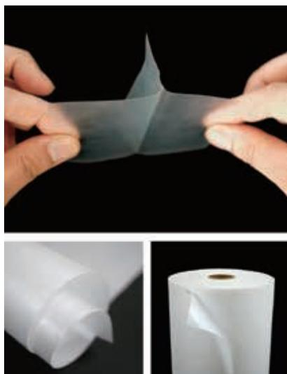
■業界に先駆けて実践してきたリサイクルペットフィルムの研究・開発が評価され、平成16年に「香川県環境配慮モデル事業所」第1号として認定されました。その後も継続的に新素材開発に注力をしてきた結果、「再生含有率ほぼ100%」「単体でヒートシールが可能」な特長を持つPETフィルムの開発に成功しました。
