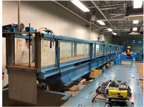
※潮流の流れを再現するための大型の水理実験装置
