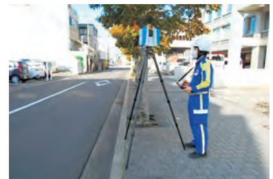
3Dレーザースキャナによる計測
