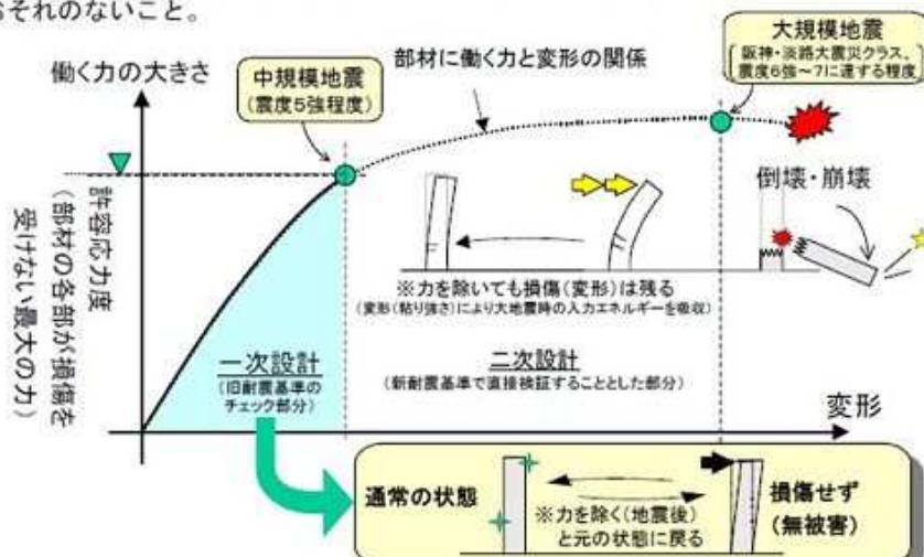
※ 二次設計には、保有水平耐力計算の他、より厳密な許容応力度等計算やより高度な構造計算方法である限界耐力計算等がある。
