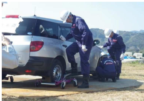
写真：ゴージャッキによる人力移動
