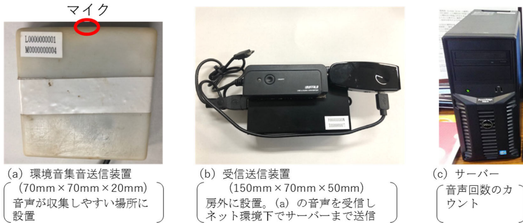
図 1. 環境音から繁殖雌牛の音声の抽出、音声回数のカウントをした装置類
