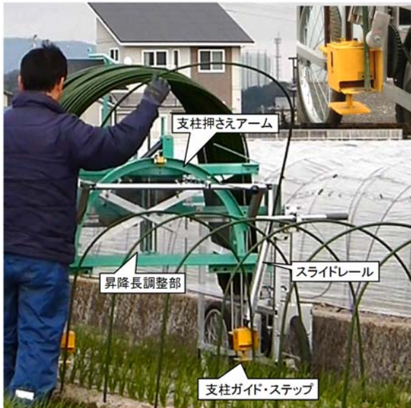
図2 支柱装填作業の様子 (支柱押さえアームは上昇時)
