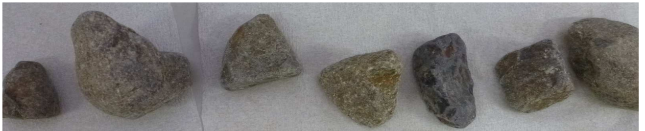
トレンチドレーン碎石摩砕洗浄処理後（3回目）
