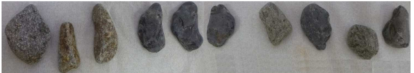
トレンチドレーン碎石摩砕洗浄処理後（6回目）
