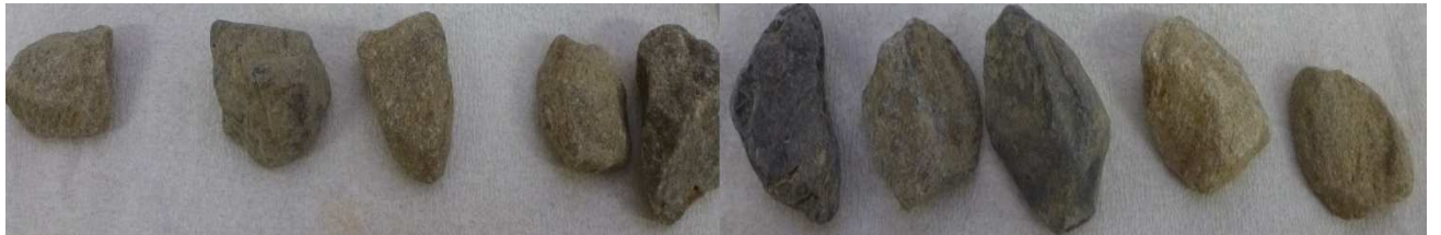
トレンチドレーン碎石摩砕洗浄処理後（1回目）
