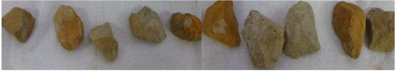
トレンチドレーン碎石摩砕洗浄処理前
