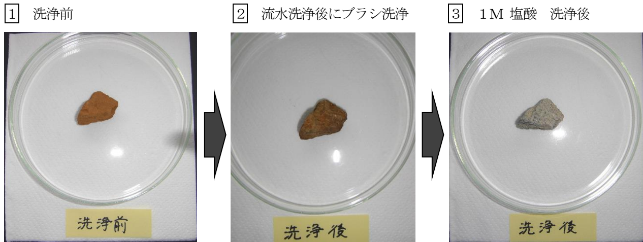
写真2 北海道トレンチドレーン砕石の洗浄試験結果 (H23. 3. 4)
