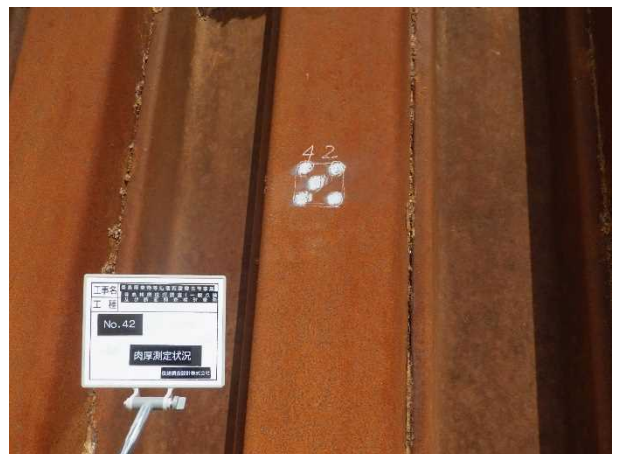
写真 6 肉厚測定箇所-研磨後 (No. 42)
