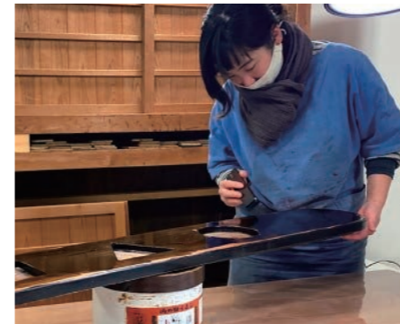
漆塗りのすべり台の制作風景。通常、乾燥した漆でかぶれることはないが、子どもの遊具であることに配慮して乾燥期間を長くしている。
